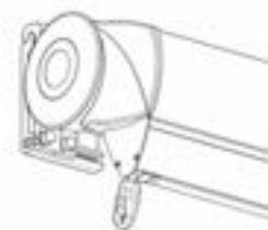
Betjäning snäckväxel för rullgardinen inkl. vev. Motor finns som tillval.
